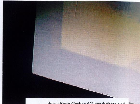
durch René Gerber AG bearbeitete und gebürstete Fräterschneide (400 Mal vergrößert).
