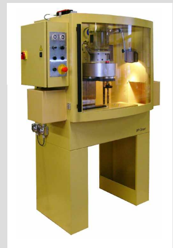
Einhausung für Ausführung mit Oszillationstisch
