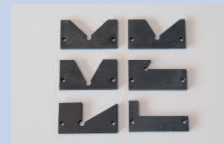
Positioniereinsätze zu Schnellspanner Positioning plates for quick clamping vice
